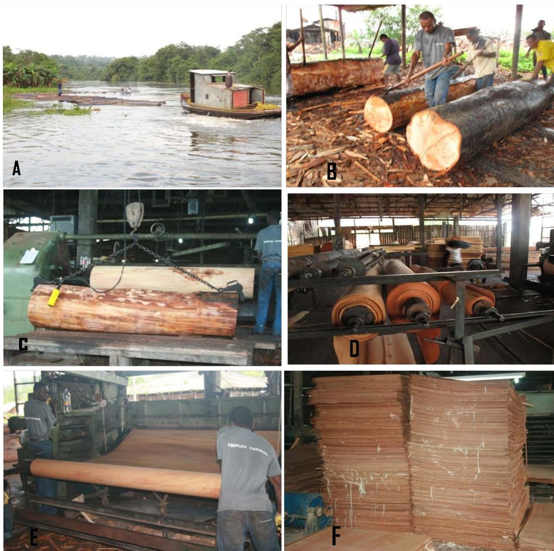
**Figura 30. a) almacenamiento y curtiembre de la madera, b) extracción de la corteza, c y e) procesamiento de la madera, d) almacenamiento del producto extraído (triplex)**
