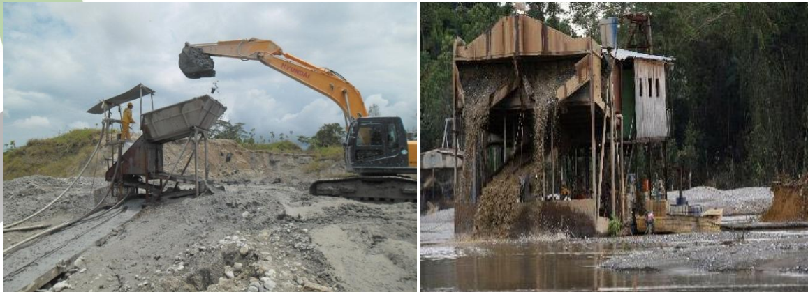
Foto 4. Sistemas mecanizados: Izq: Retroexcavadora mina Continental Platinum Gold - Condoto. Der: Dragas Hidráulica.
