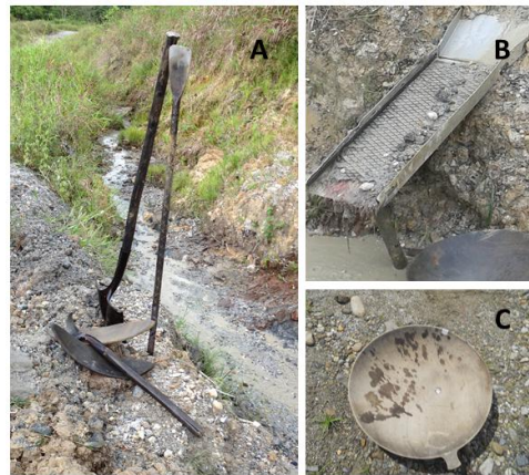
Foto 2. Izq: Sistema de Explotación agua corrida – Aguas Claras (Unión Panamericana). Der: Herramientas: A) Almocafre, Cachos, Barra y Pala; B) Canalón de metal C) Batea
