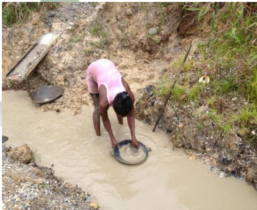
Foto 2. Izq: Sistema de Explotación agua corrida – Aguas Claras (Unión Panamericana). Der: Herramientas: A) Almocafre, Cachos, Barra y Pala; B) Canalón de metal C) Batea
