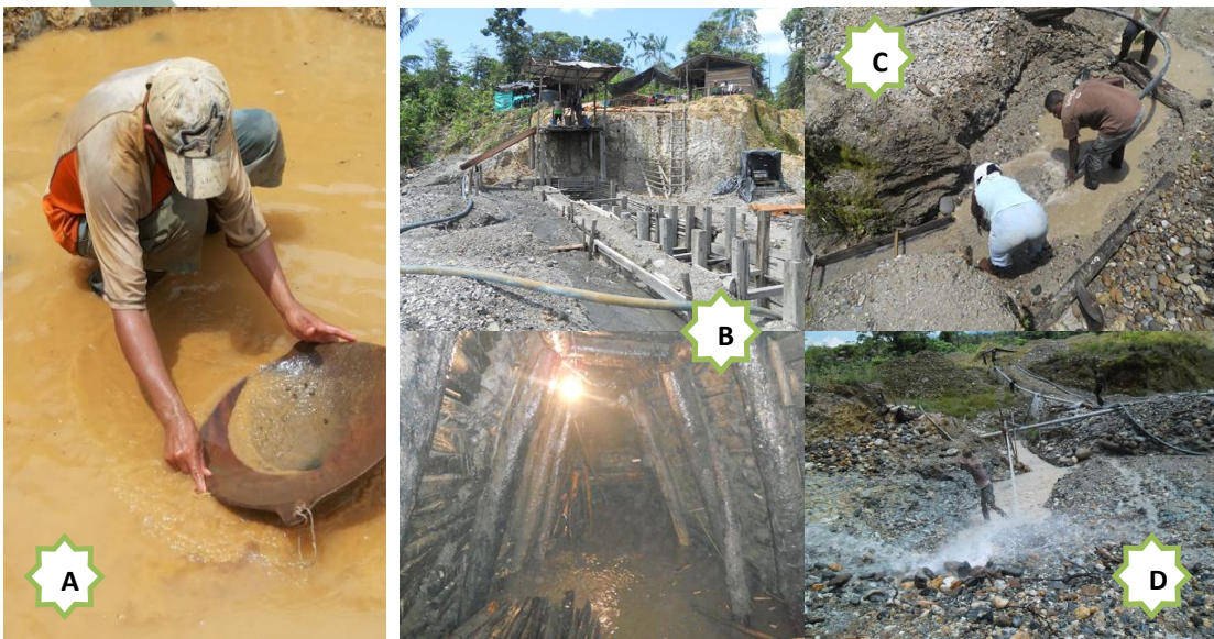
Foto 1 A. Mazamorreo (Cocoseco) B. Sistema de Guache (Cocomaupa) C. Peladero o chorriadero (Agua Clara, Cocomaupa) D. Mina de Agua Corrida (Inversiones Martínez, Návita)
