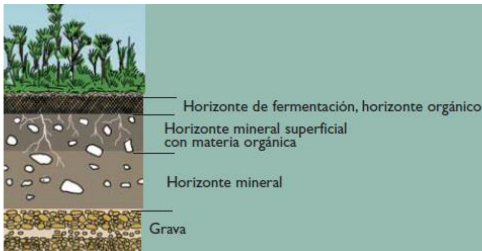
Figura 4. Estructura típica del relleno de excavaciones mineras
