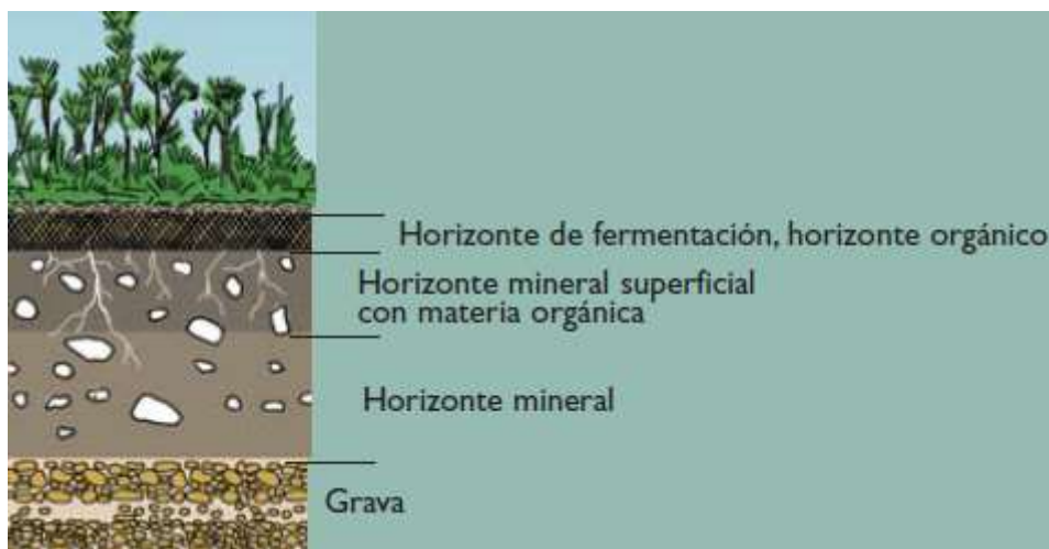
Figura 4. Estructura típica del relleno de excavaciones mineras
